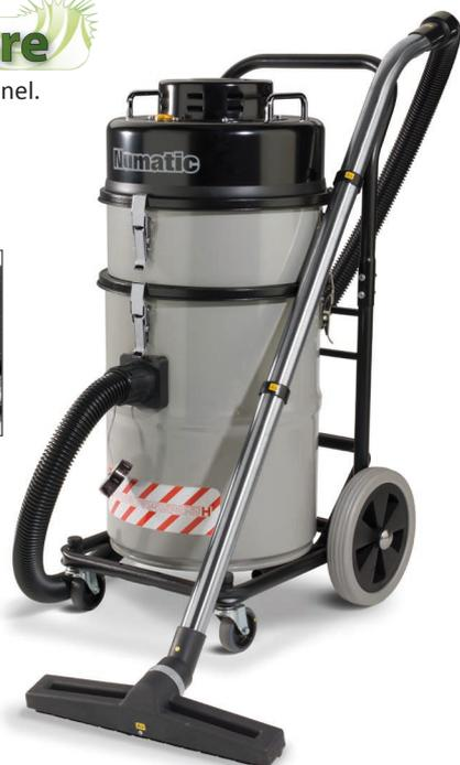
Aspirateur anti-statique de classe H (EN60335-2-69), équipé d'un filtre absolu HEPA H13 (avant et après moteur), et bouchon de sécurité, destiné aux zones où l'électricité statique est à bannir (fabrication de composants électroniques etc...).
